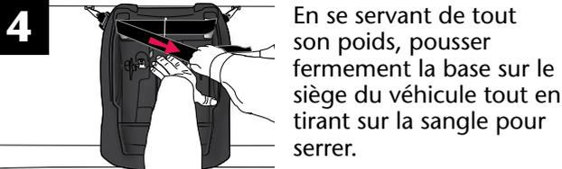
**4** En se servant de tout son poids, pousser fermement la base sur le siège du véhicule tout en tirant sur la sangle pour serrer.
