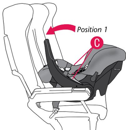
Appuyer sur les deux déclencheurs de la poignée **C** et déplacer la poignée en **Position 1**.
